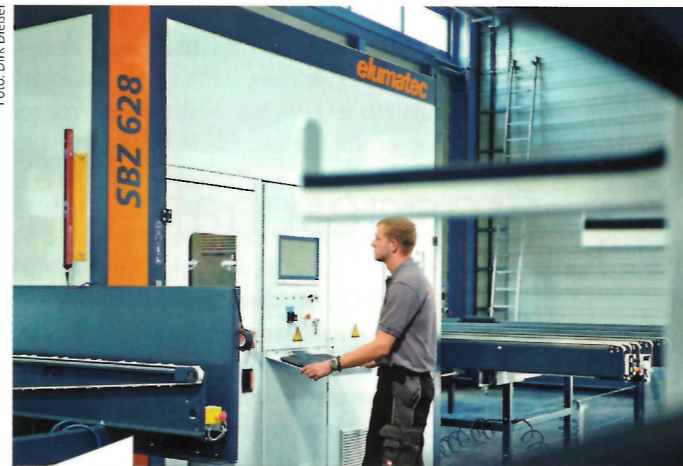
Bei dem Stabbearbeitungszentrum SBZ 628 lassen sich in einem einzigen Durchlauf dank eines Rotationsmoduls bis zu acht verschiedene Werkzeuge einsetzen und der Zuschnitt einfach und schnell realisieren.
